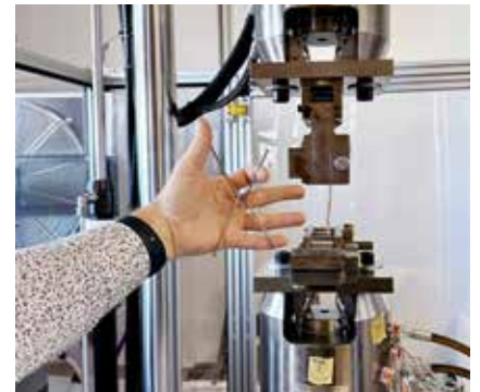
Welche Schwingungen hält das Stahlnetz aus? In diesem Gerät lässt sich genau diese Frage testen.
